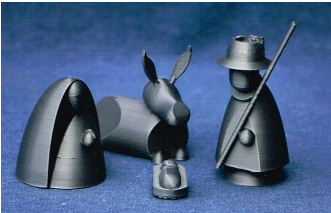
Drie D printen , kerstgroep, figuren, Geprint van gesmolten PLA (Poly Lactide).balletjes Nederland, Europa Privé verzameling
